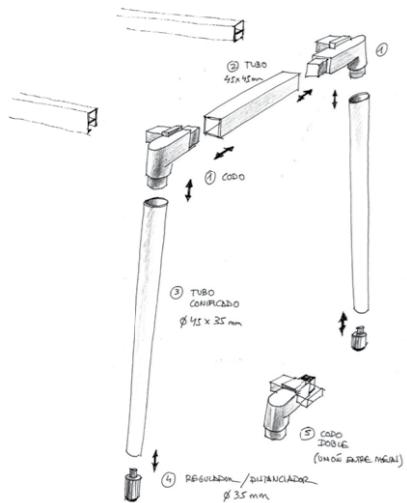
Reconfiguraciones rápidas, sencillas y fiables gracias a su estructura totalmente desmontable y de fácil montaje.
