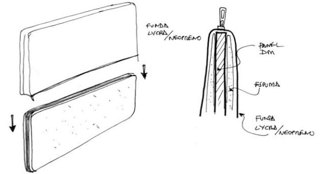
Los separadores móviles y desplazables que permiten la rápida configuración de los puestos, según la actividad y el número de usuarios, son especialmente eficaces en los bench o/y puestos compartidos.
